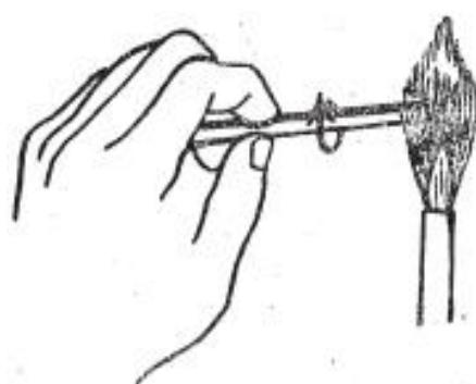
चित्र 1.2 काँच की नली के किनारों को चिकना करना
