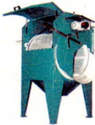
(ੳ) ਸਮੂਹ ਵਿੱਚ ਡਰਮ ਵਾਲੀ ਪੁਆਈ ਕਰਨ ਵਾਲੀ ਮਸ਼ੀਨ (Batch Washer-Drum Type)
