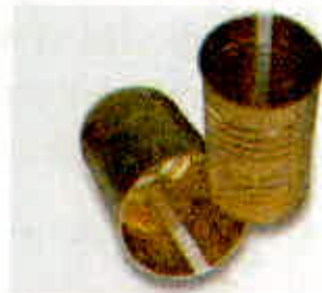
ਚਿੱਤਰ 1: ਤਿੰਨ ਟੁਕੜਿਆਂ ਵਿੱਚ ਕਲੀ ਰਹਿਤ ਸਟੀਲ ਤੋਂ ਬਣੇ ਡੱਬੇ (Three Piece cans made up of Tin free steel)
