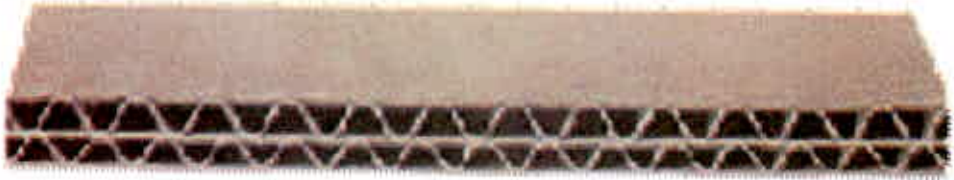
ਚਿੱਤਰ 8 : ਦੂਹਰੀ ਕੰਧ ਜਾਂ ਜੌੜੀ ਗੱਦੀ ਵਾਲੇ ਫਾਈਬਰ ਬੋਰਡ (Double wall or Twin cushioned fiberboard)
