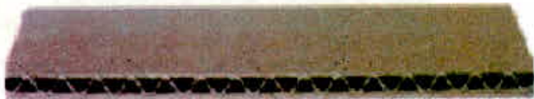
ਚਿੱਤਰ-7: ਇੱਕਹਰੀ ਕੰਧ ਬੋਰਡ ਜਾਂ ਦੁਪਾਸੜ ਬੋਰਡ (Single wall board or Double faced board)
