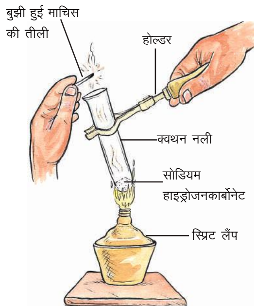
चित्र क्रमांक-4 : सोडियम हाइड्रोजनकार्बोनेट का अपघटन तथा कार्बन डाइऑक्साइड का उत्सर्जन और परीक्षण
